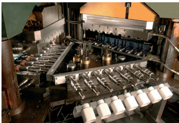
Adop France dispose de deux machines d'injection-soufflage pour ses développements et la mise au point finale des outillages.
